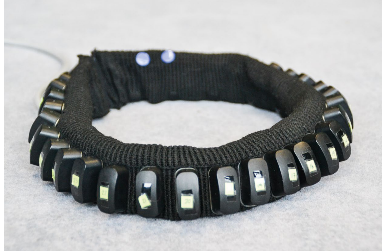
Durch Vibration weist der Gürtel den Weg im Freien wie in geschlossenen Räumen.
