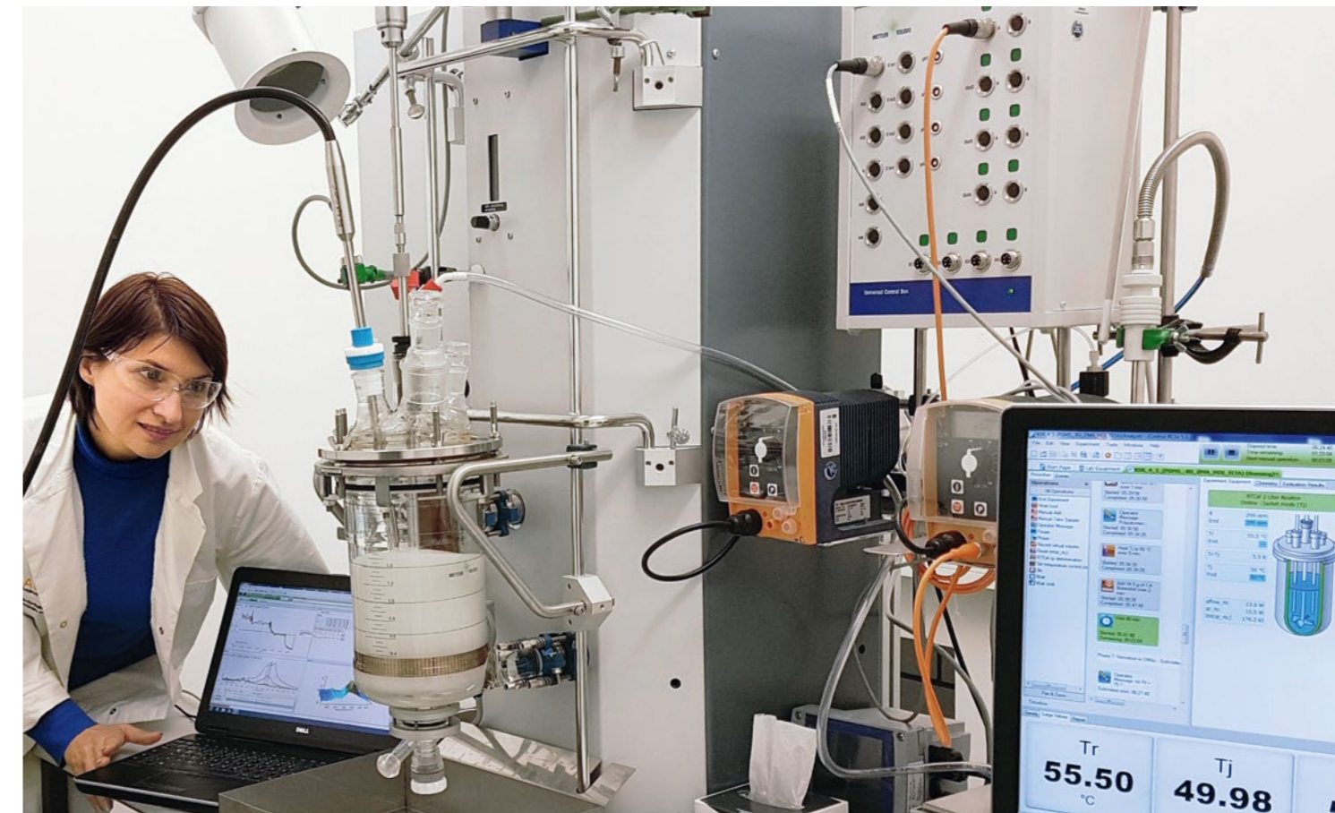
Larysa Kutuzova, promovierte Chemikerin und Leiterin des Forschungslabors „Thermal Analysis & Calorimetry“, am Reaktionskalorimeter.
